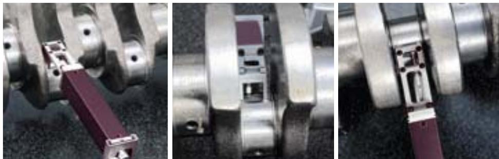
Установите измерительный датчик на измеряемую поверхность колчатого вала. Новый блок привода тип "S" с возможностью поперечного сканирования быстро и точно произведет измерения шероховатости поверхности по осевому направлению. Функция поперечного сканирования упрощает процесс измерения шероховатости поверхности даже в ограниченном пространстве, что затруднительно при использовании стандартных измерительных приводов с продольным сканированием.
