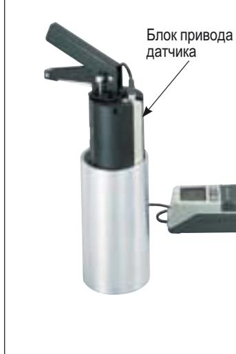
Блок привода датчика
